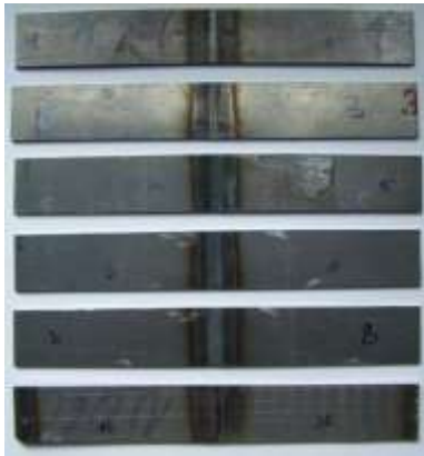
Fig.11 Tensile test samples.
